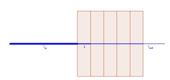
Die Dicke der Schicht sei d Längeneinheiten. 90% der Strahlung werden durchgelassen(pro Schichteinheit), daraus ergibt sich:
