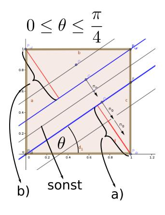
Wenn der Strahl von "unten" hereinwandert, gibt es 2 Grenzfälle (blau) bei denen er eine horizontale und eine vertikale Grenze durchkreuzt, dazwischen liegt der Fall mit 2 vertikalen Schnitten.
