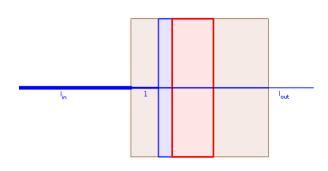
Die Dicke der Schichten sei  $d_1, d_2 \dots d_4$  Längeneinheiten mit den Absorptionskoeffizienten  $\alpha_1, \alpha_2, \dots \alpha_4$ . Daraus ergibt sich:
