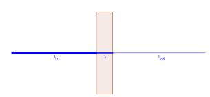
Die Dicke der Schicht sei 1 Längeneinheit. 90% der Strahlung werden durchgelassen, daraus ergibt sich:
