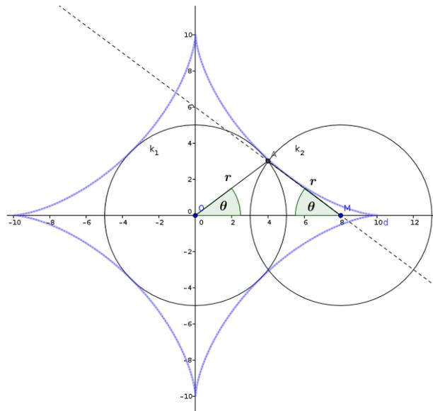
Normalerweise nimmt man allerdings nicht die horizontale Verschiebung des Kreismittelpunkt als Parameter, sondern den “Winkelabstand”  $\theta$  des verschiebbaren Kreises. Dadurch müsste auch die Symmetrie, die diese Kurve offensichtlich hat, sich in ihrem erzeugenden Term widerspiegeln (rechte Zeichnung)
